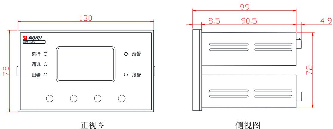
AIM-T500 绝缘监视仪的正视图、侧视图如上图所示。
